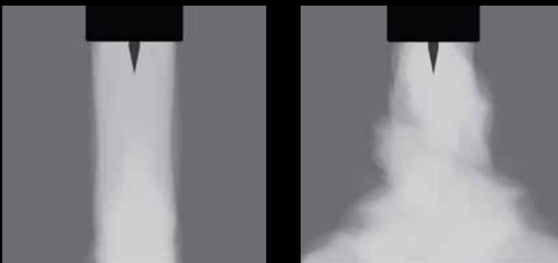
Die Abbildung auf der rechten Seite zeigt einen stark verwirbelten Gasstrom, der eine schlechte Abschirmung und einen erhöhten Gasverbrauch zur Folge hat.
