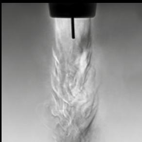
Der Schutzgasstrom hat eine wesentliche Auswirkung auf die Schweißqualität. Normalerweise ist Schutzgas unsichtbar, aber mit der Schlieren-Bildgebungstechnologie ist es möglich, den tatsächlichen Gasstrom zu beobachten. Dies veranschaulicht, wie der Aufbau und die Verschleißteile des Flexlite GX-Schweißbrenners einen gleichmäßigen Gasstrom und eine bessere Schutzgasabdeckung ermöglichen.
