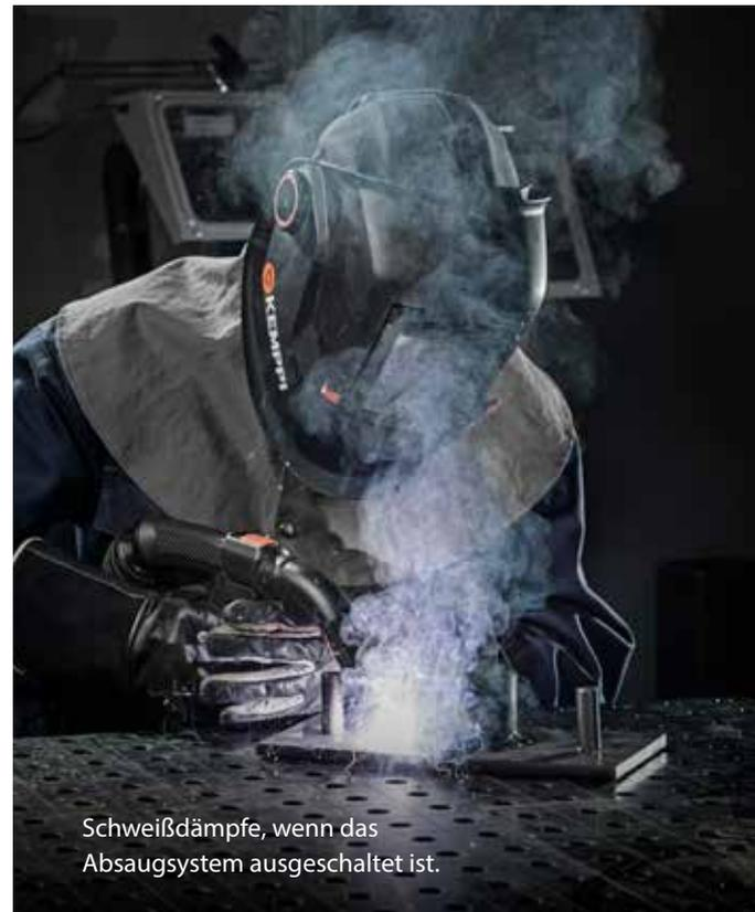
Schweißdämpfe, wenn das Absaugsystem ausgeschaltet ist.
