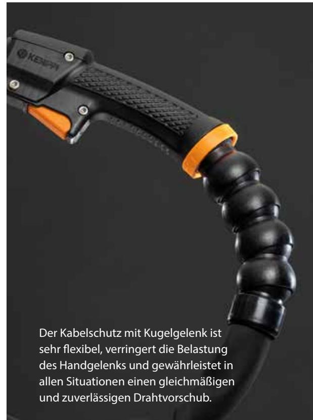
Der Kabelschutz mit Kugelgelenk ist sehr flexibel, verringert die Belastung des Handgelenks und gewährleistet in allen Situationen einen gleichmäßigen und zuverlässigen Drahtvorschub.
